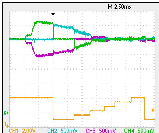
Ähnlich ist die Lage beim Betrachten der drei Motorphasen-Signale beim Loslaufen des Motors aus dem Stand. Auch hier wechseln bei jedem Kommutierungs-Schritt die Strom-Kombinationen.
