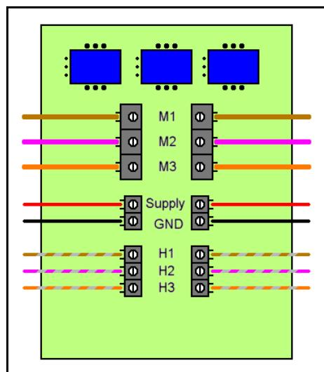
Die Hall-Versorgung wird im Gerät einfach durchgeleitet, aber nicht zur Versorgung des Geräts herangezogen. Die Verkabelung ist aber einfacher durchzuführen, wenn man alle Kabelenden links und recht auflegt, so dass die Kabelfarben direkt verglichen werden können.
