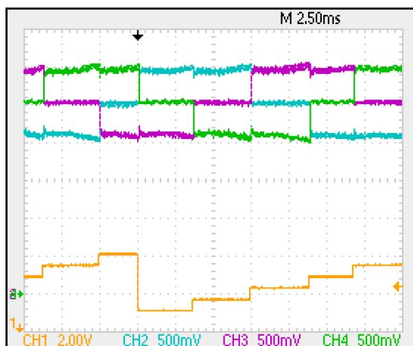
Wenn man dem Motor eine gleichmäßige Momentenbelastung vorgibt, dann entstehen Ströme wie im nebenstehenden Bild. Man erkennt, dass immer ein Signal Null ist.
