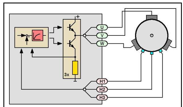
(je nach Rotorstellung, die durch die Hall-Sensoren erfasst wird). Dadurch reicht die Betrachtung einer einzigen Motorphase nicht aus, um den Motorstrom zu bewerten.
