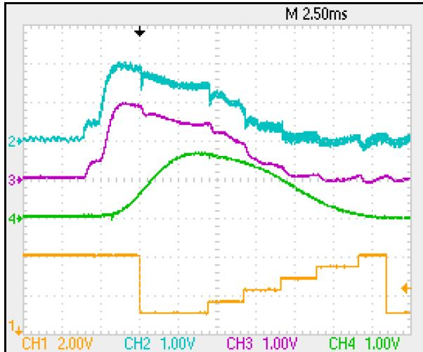
Das obere Signal (2) ist jetzt der äquivalente Motorstrom. Es ist oft hilfreich, die Stromsignale mit einem Tiefpass-Filter zu bearbeiten. Dadurch können z.B. Reste der PWM beseitigt werden, die sonst die Übersicht stören. Ganz nach Aufgabenstellung sind aber unterschiedliche Filter-Charakteristiken erwünscht.
