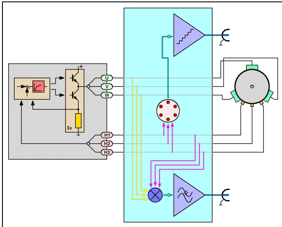
Weiterhin wird ein Rotorlagen-Signal erzeugt, aus dem man die korrekte Kommutierung überprüfen kann. Dazu wird den 6 Schritten der Block-Kommutierung einmal als LED-Uhr und einmal als analoges Stufensignal aufbereitet, wodurch zwei sehr intuitive Hilfsmittel bereitstehen.
