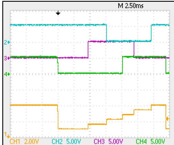
Die oberen drei Signale sind die Hall-Signale beim Loslaufen des Motors aus dem Stand. Diese drei digitalen Signale werden im Gerät zu einem kompakten analogen Signal zusammengefasst, das im unteren Teil des Bild zu sehen ist (1). Die sechs Schritte der Block-Kommutierung führen zu einem stufenförmigen Signal, aus dem man auch die Drehrichtung ableiten kann.
