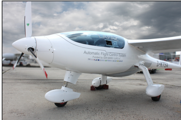
Technologie-Demonstrator mit vollautomatischem Flugsteuerungssystem: Die Flugsteuerung kann das Flugzeug autonom mit voller Autorität für Überwachungsaufgaben steuern (einschließlich Start und Landung).
