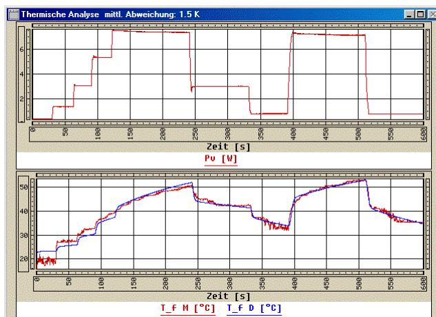
**Zeitverläufe:** Das obere Diagramm zeigt die Verlustleistung, die auf den Motor wirkt. Das untere Diagramm zeigt die gemessene Temperatur (rot) sowie die geschätzte Temperatur (blau), die sich aus den identifizierten Parametern ergibt.
