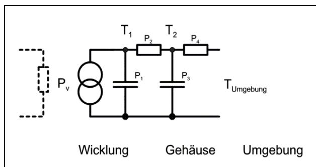
**Ersatzschaltbild zur Modellierung des thermischen Verhaltens:** Die Verlustleistung  $P_v$  in der Wicklung fließt durch das Gehäuse in die Umgebung. Die Temperaturen  $T_1$  und  $T_2$  entsprechen den Temperaturen von Wicklung und Gehäuse. Die Parameter  $P_1$  bis  $P_4$  ergeben sich aus den physikalischen Gegebenheiten.
