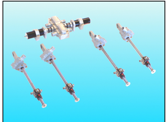
Landeklappenantrieb für ein Geschäftsreiseflugzeug: Die beiden Motoren treiben über das zentrale Getriebe die vier Aktuatoren an. Die Verbindung erfolgt über flexible Wellen, die auf dem Foto nicht zu sehen sind.
